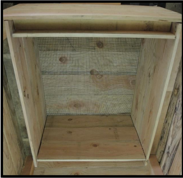
Figure 15 : Boîte chaude, intérieur de la cloche isolée, avec grillage pour accroche - ©A. Cartier
